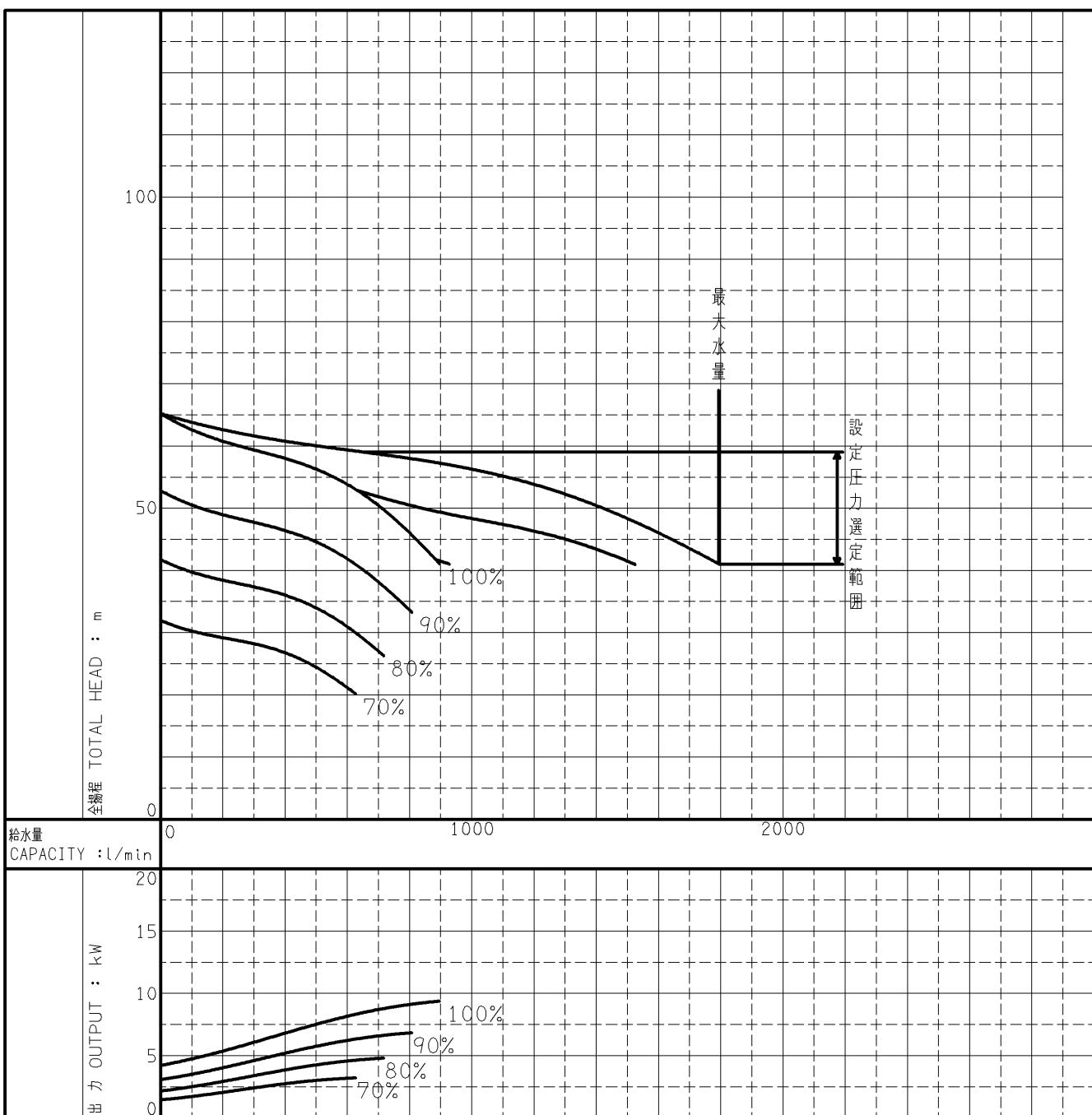
1. 吐出し圧力は、上記設定圧力選定範囲で設定してください。
