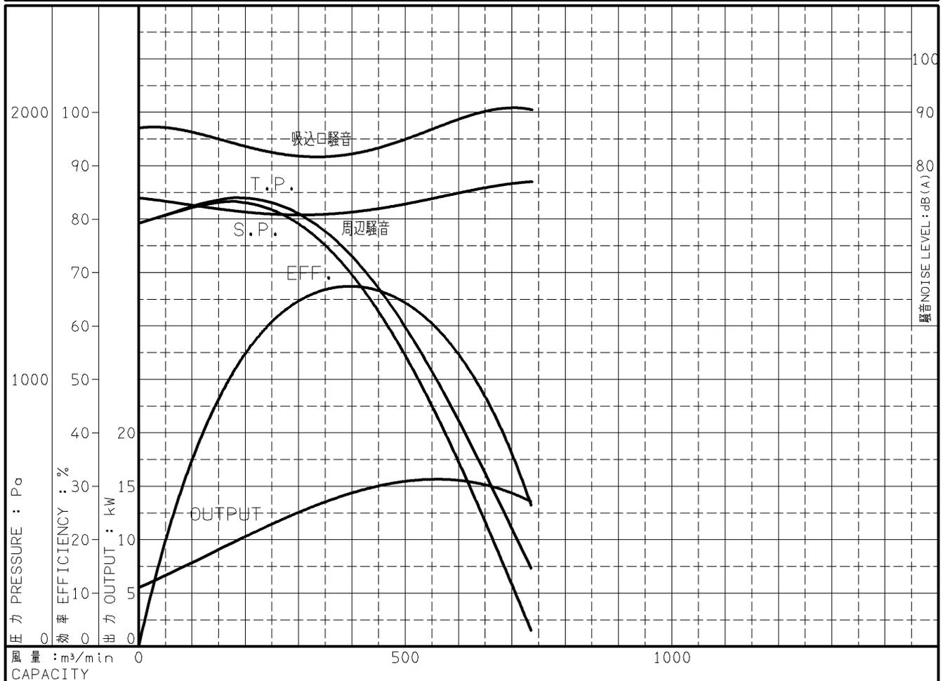
注) 性能試験はJIS B 8330 (図1(B))に準拠します。 この性能曲線は標準吸込状態(20°C, 1.2kg/m<sup>3</sup>)におけるものです。
