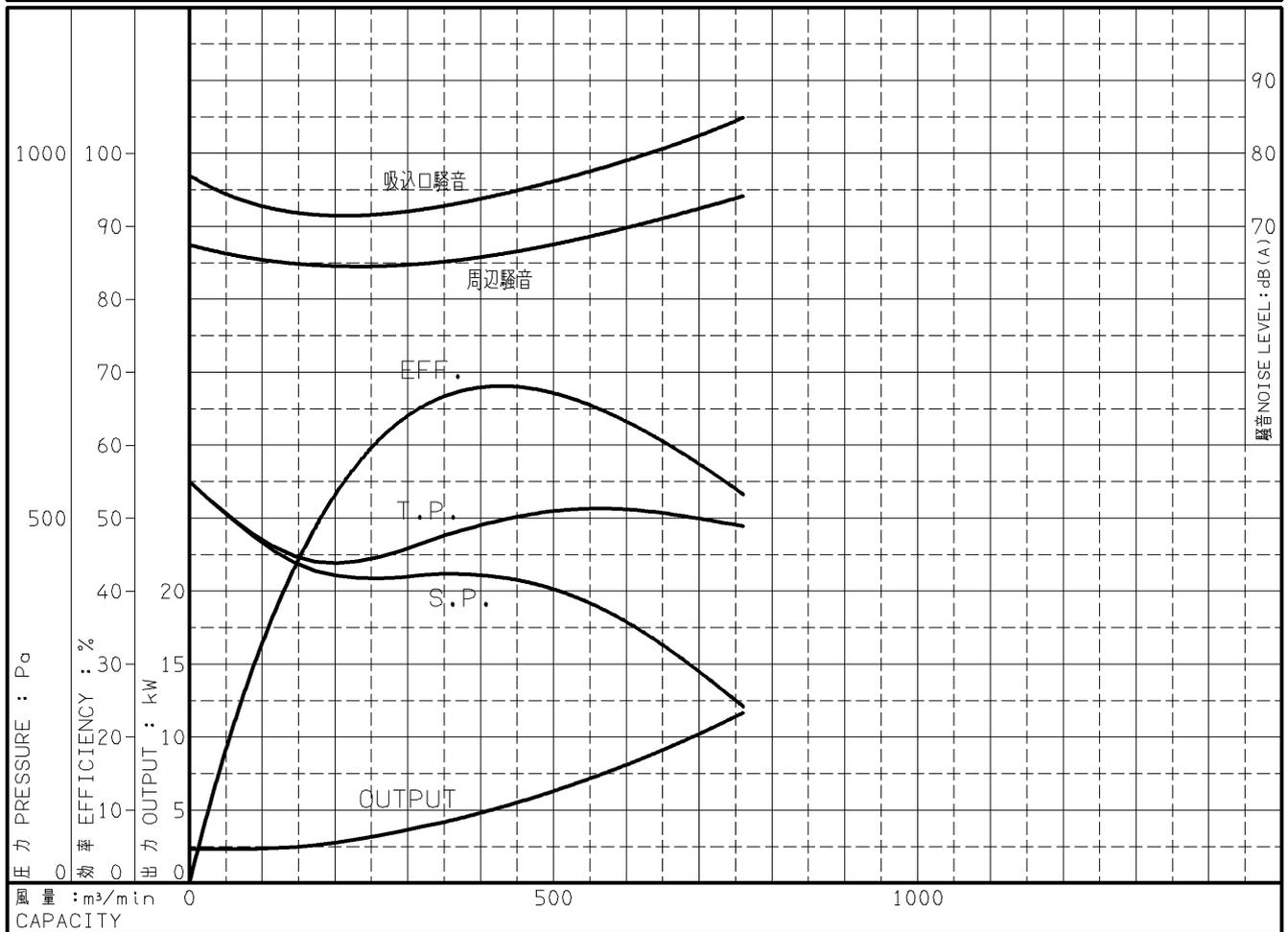
注) 性能試験はJIS B 8330 (図1(B))に準拠します。 この性能曲線は標準吸込状態(20°C, 1.2kg/m³)におけるものです。
