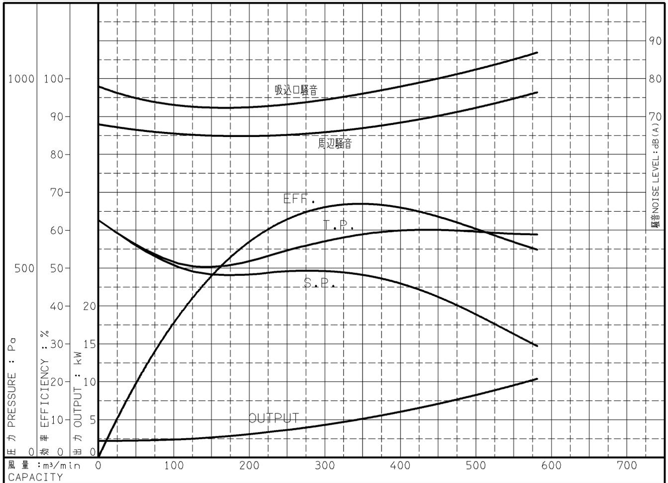
注) 性能試験はJIS B 8330 (図1(B)) に準拠します。 この性能曲線は標準吸込状態 (20°C, 1.2kg/m³) におけるものです。
