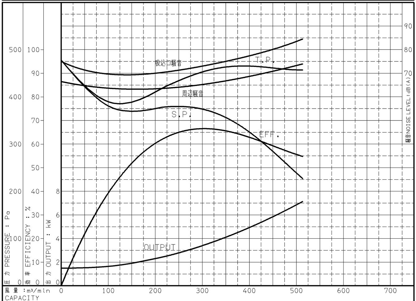
注) 性能試験はJIS B 8330 (図1(B))に準拠します。
