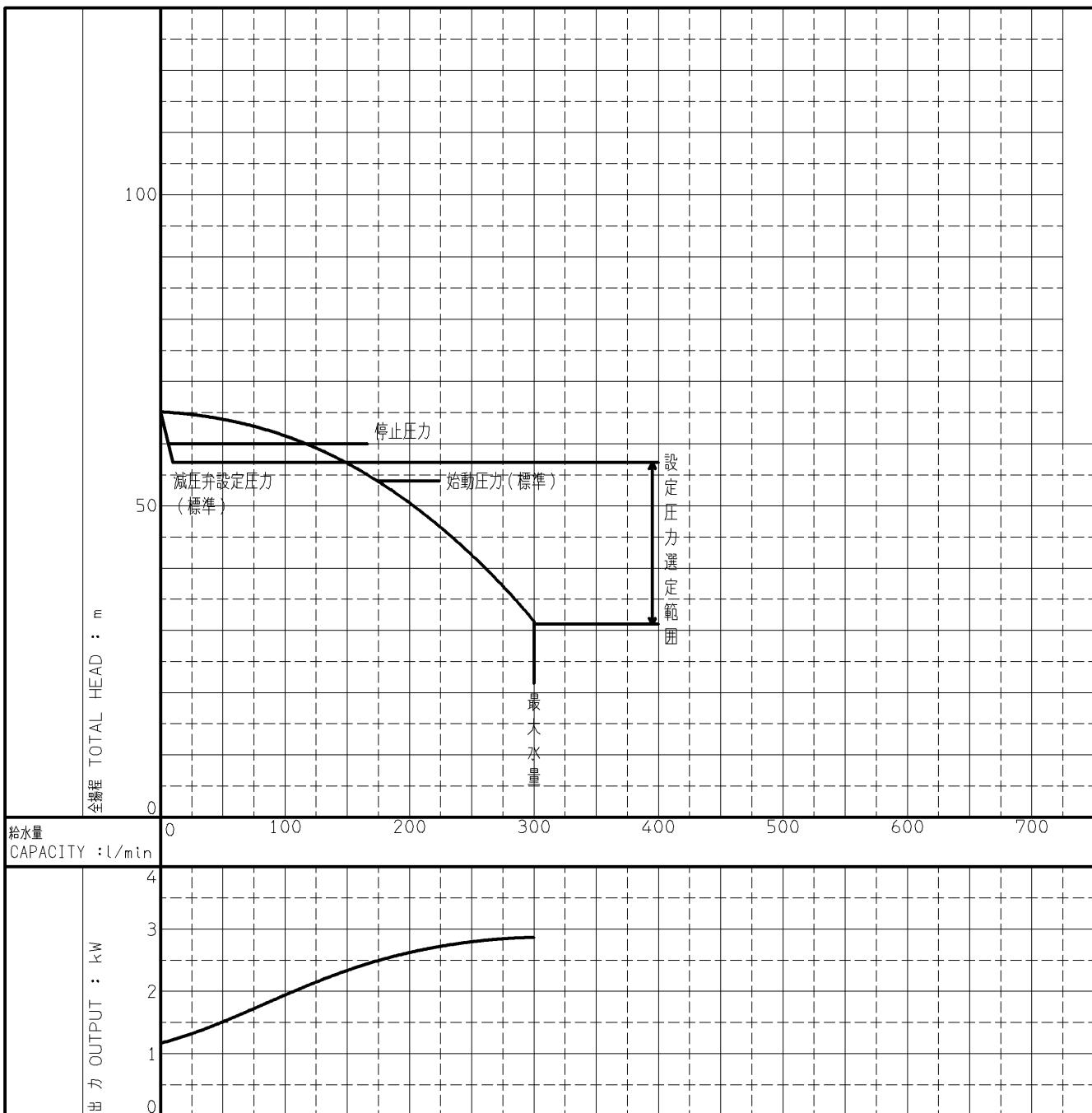
1. 減圧弁設定圧力は工場出荷時の値です。変更する場合は設定圧力選定期間内で設定して下さい。始動圧力は減圧弁設定圧力-0.029MPaとして下さい。
