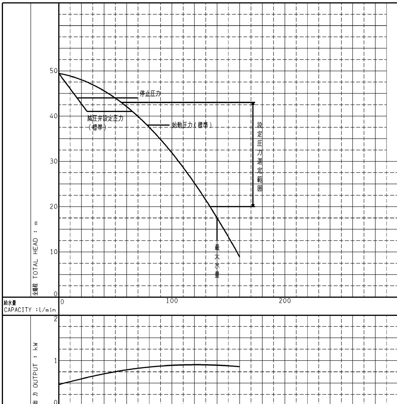
1. 減圧弁設定圧力(標準)は工場出荷時の値です。変更する場合は設定圧力選定範囲内で設定して下さい。始動圧力は減圧弁設定圧力-0.3kWとして下さい。
