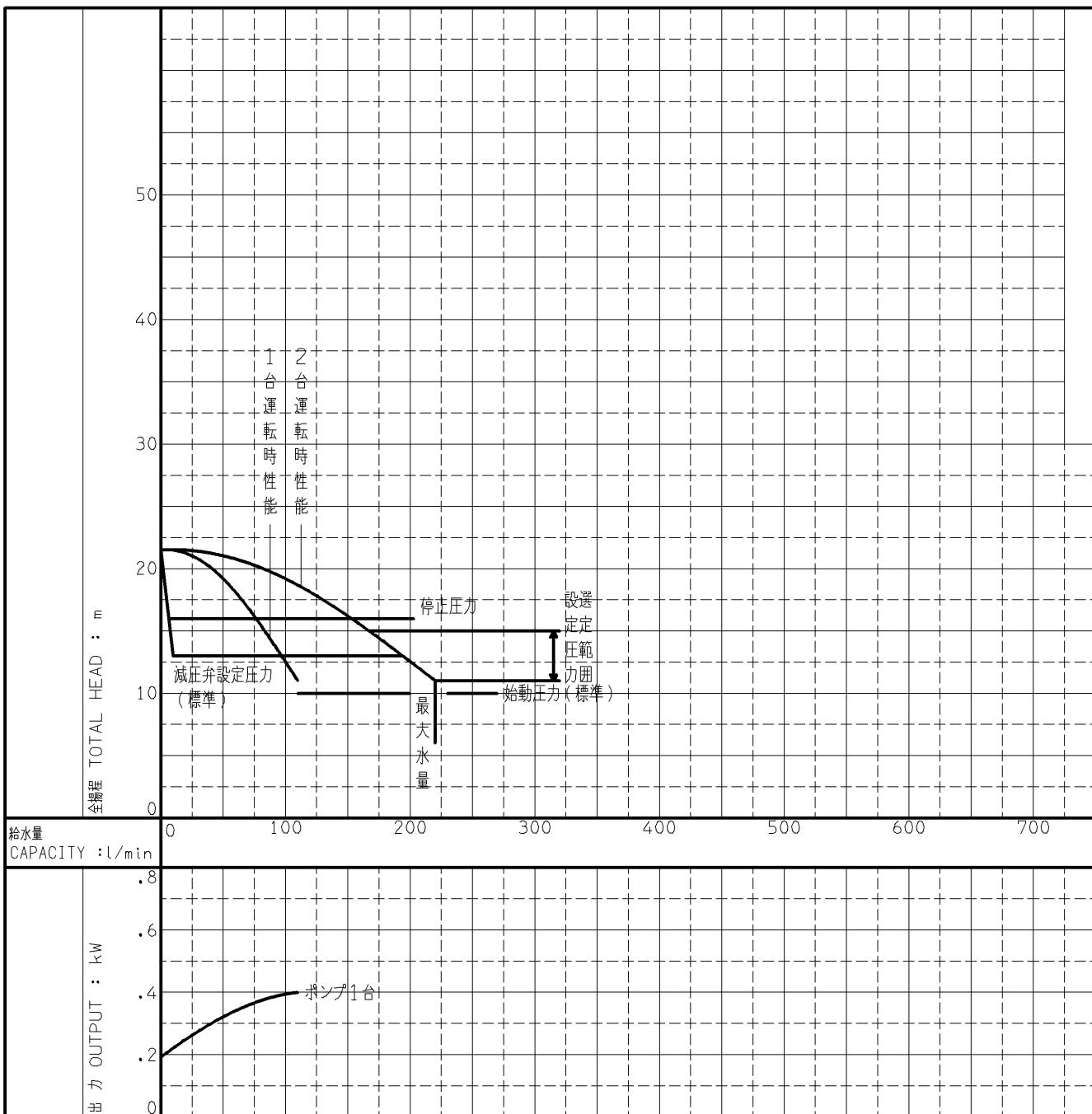
1. 減圧弁設定圧力は工場出荷時の値です。変更する場合は設定圧力選定範囲内で設定して下さい。始動圧力は減圧弁設定圧力-0.029MPaとして下さい。
