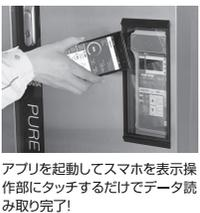
アプリを起動してスマホを表示操作部にタッチするだけでデータ読み取り完了!
