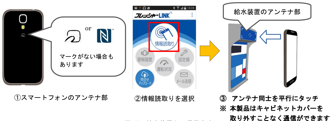
図 18 給水装置との通信方法
