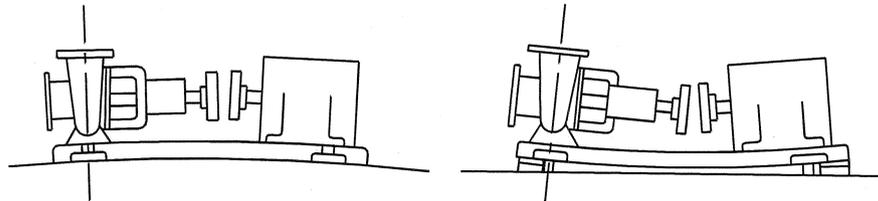
図2：据付時の軸芯のずれ
