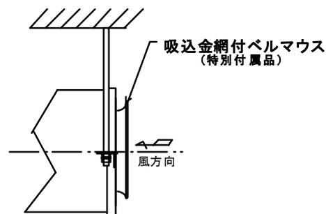
図3 吸込金網付ベルマウス
