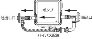
2階・3階での給水量が大きく吐出し圧力が低い場合
