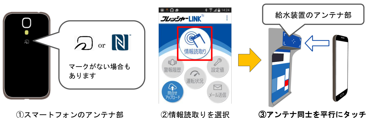
図 35 給水装置との通信方法
