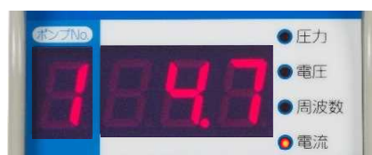
電流表示 (例: 1号ポンプ 4.7A)
