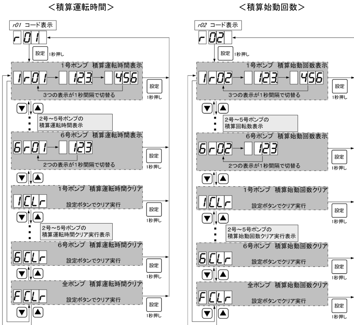
図 6-20 積算運転時間と積算始動回数の表示例
