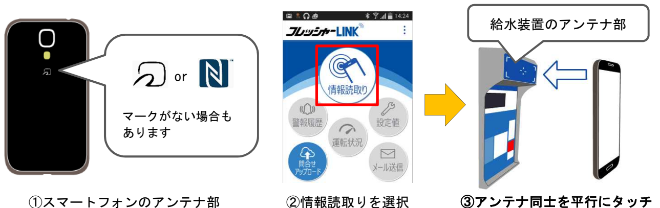
図 32 給水装置との通信方法
