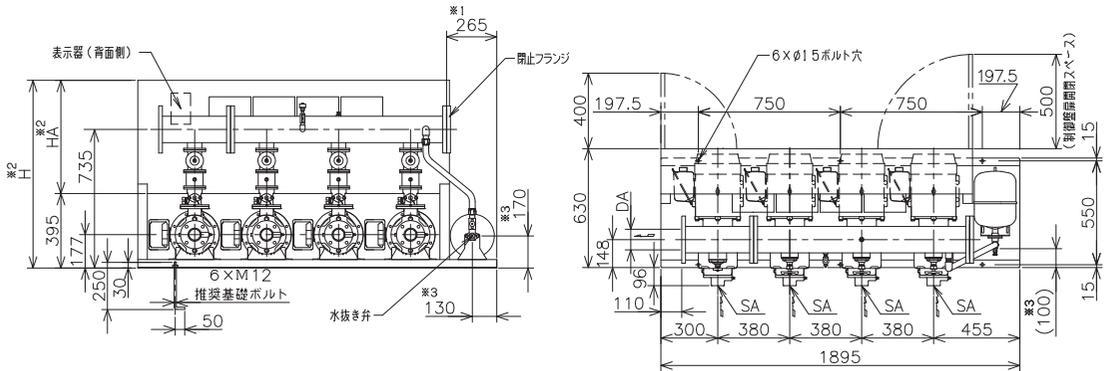
注) ①吐出し方向をポンプ吸込み側から見て右側に変更する場合は、閉止フランジ及びパッキンを取り外し取付け面を交換してください。この時、吐出し面は※1の寸法となります。
