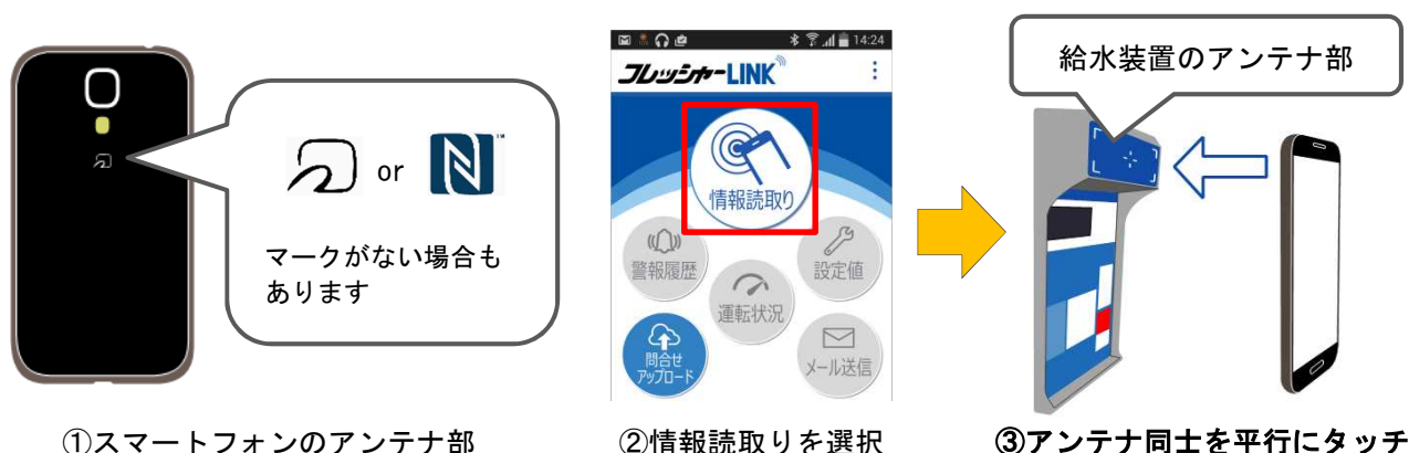
図 30 給水装置との通信方法
