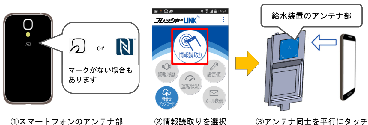
図 6-4-1 給水装置との通信方法
