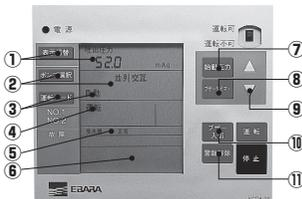
●表示画面では、吐出し圧力 (m)・(MPa)・ポンプ運転電流・運転方式・選択ポンプ・受水槽の状態・ポンプ異常内容等の豊富な情報を読みやすい液晶で表示します。
