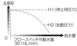
■選定図 60Hz [同期速度：3600min<sup>-1</sup>]
