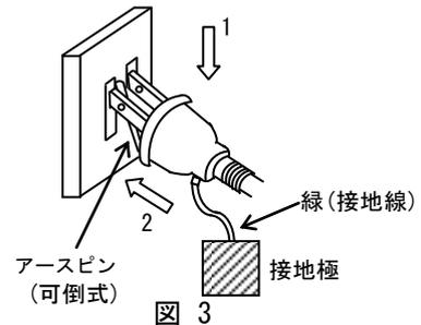
(b) コンセントおよび接続端子の緩みはポンプ停止の原因となりますのでしっかりと取付けてください。
